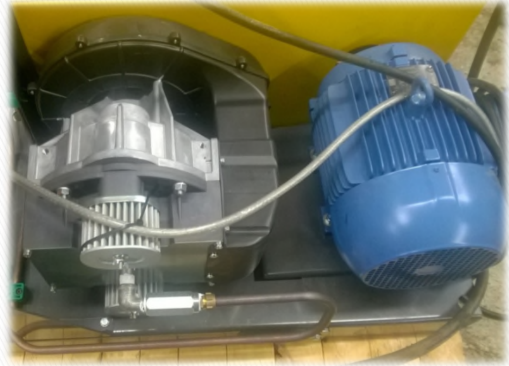
Öljytön huoltovapaa Laser Gasin valmistama kompressori
